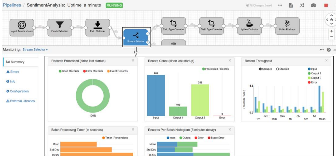
شکل شماره ۱۴: توسعه گرافیکی فرایند اجرای مدل یادگیری ماشینی (نسخه پیشرفته)
